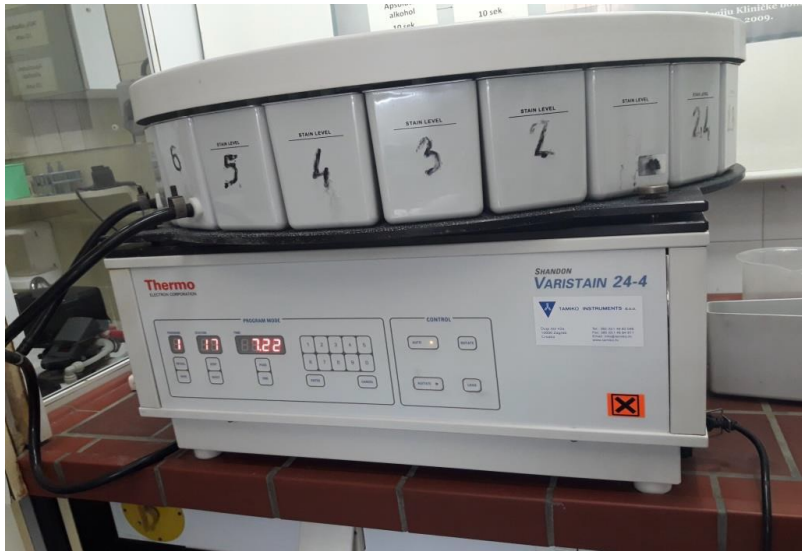
Slika 10. Aparat za bojanje uzoraka metodom po Papanicolaou (iz fundusa Kliničkog zavoda za kliničku citologiju KBC-a Osijek)
