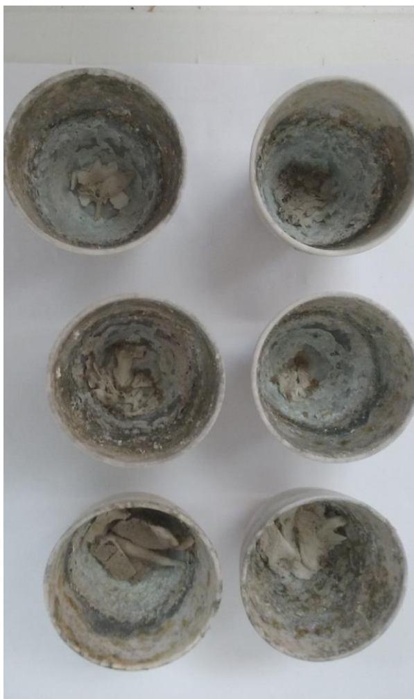
Slika 4.6. Keramički lončići za žarenje štitnih hrskavica
