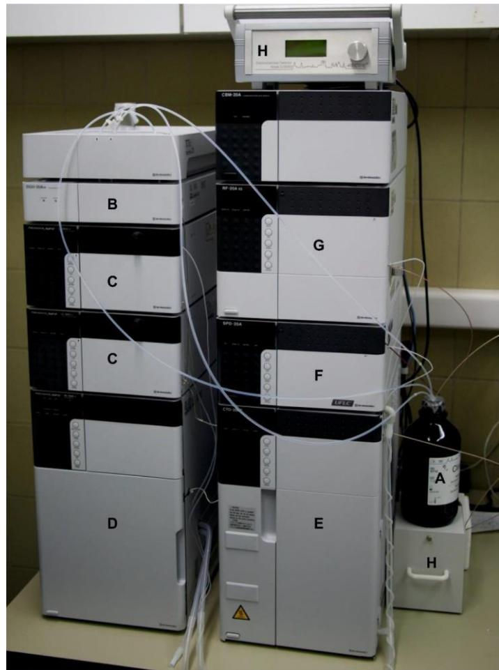
Slika 1. Tekućinski kromatograf visoke djelotvornosti (HPLC): A – spremnik mobilne faze, B – otplinjavač, C – pumpe, D – automatski injektor, E – pećnica, F – UV/VIS detektor, G – fluorescentni detektor, H – elektrokemijski detektor
