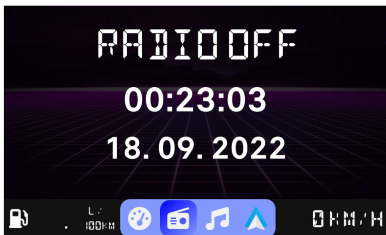
Slika 3.8: Prikaz informacija o satu. Ovaj izbornik se prikazuje kada se radio isključen, a automobil uključen. Prikazuje trenutno vrijeme i datum.
