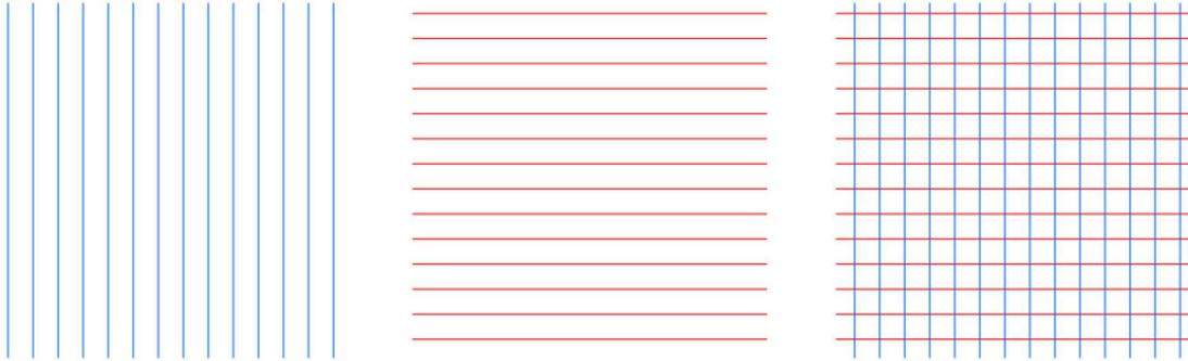
Slika 5: Ekvipotencijalne linije i strujnice za  $\omega(z) = z$ .
