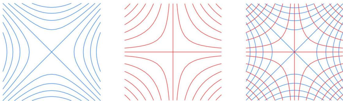
Slika 6: Ekvipotencijalne linije i strujnice za  $\omega(z) = \frac{1}{2}z^2$ .
