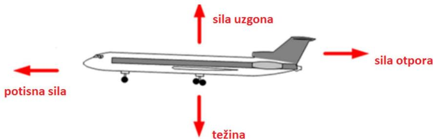
Slika 2: Sile koje djeluju na zrakoplov tijekom ustaljenog horizontalnog leta
