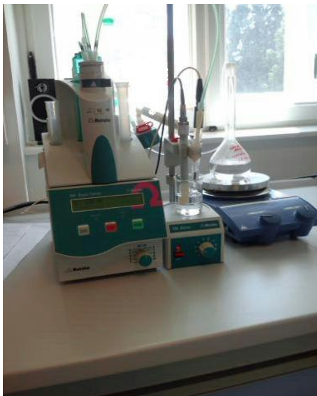
Slika 7: Metrohm 765 sustav za doziranje
