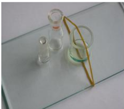
Slika 8: Izrada senzorske PVC membrane za tenzidnu elektrodu
