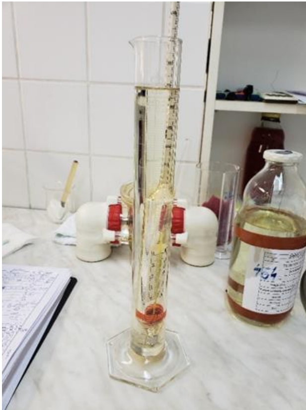
Slika 5. Mjerenje gustoće ulja.
