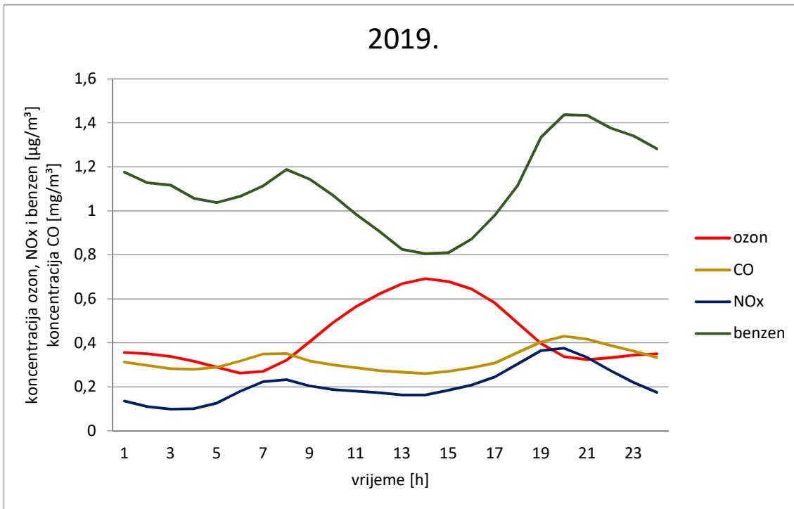
Slika 4.2. Dnevni hod izmjerениh koncentracija ozona, ugljikovog(II) oksida, dušikovih oksida i benzena u 2019. godinu, izmjerena u Osijeku, ( $[O_3 \text{ i } NO_x] = 10^{-2} \mu\text{g}/\text{m}^3$ )
