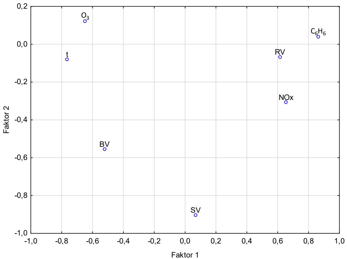
Slika 4.5. Dvodimenzionalan dijagram analize glavnih komponenata za Osijek, ( $O_3$ ) – ozon, ( $NO_x$ ) – dušikovi oksidi, ( $C_6H_6$ ) – benzen, ( $RV$ ) – relativna vlažnost, ( $t$ ) – temperatura, ( $SV$ ) – smjer vjetra, ( $BV$ ) – brzina vjetra tijekom 2018. i 2019. godine.
