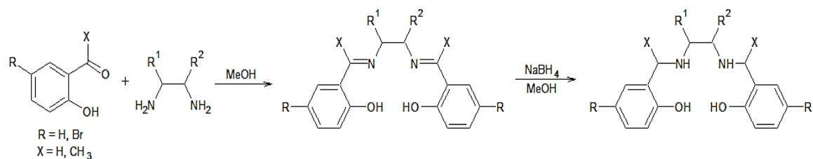
**Slika 9.** Shematski prikaz sinteze i redukcije Schiffovih baza (SB01-SB09). [15]
