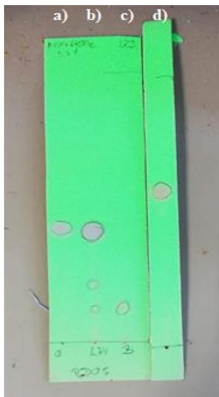
**Slika 18.** Silikagel pločica tankoslojne kromatografije za uzorke (pod UV svjetlom pri 254 nm):
