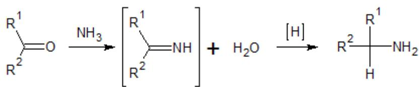
*Slika 3. Prikaz reakcije nastajanja primarnog amina iz aldehida.*
