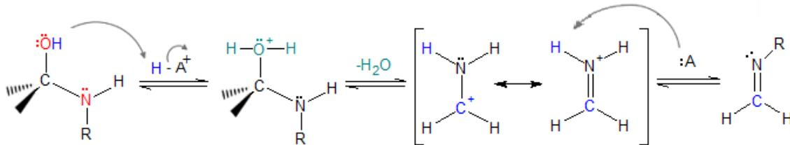
*Slika 7. Mehanizam pretvorbe karbinolamina u imin. [14]*
