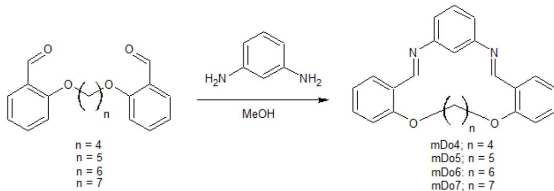
**Slika 11.** Shematski prikaz sinteze Schiffovih baza mDo4-mDo7.
