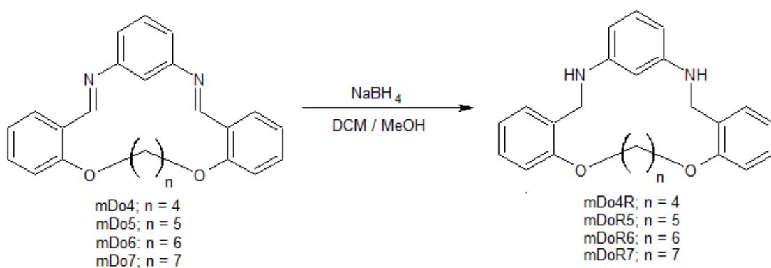
**Slika 14.** Shematski prikaz sinteze sekundarnih amina pomoću  $\text{NaBH}_4$  reduksijskog sredstva.
