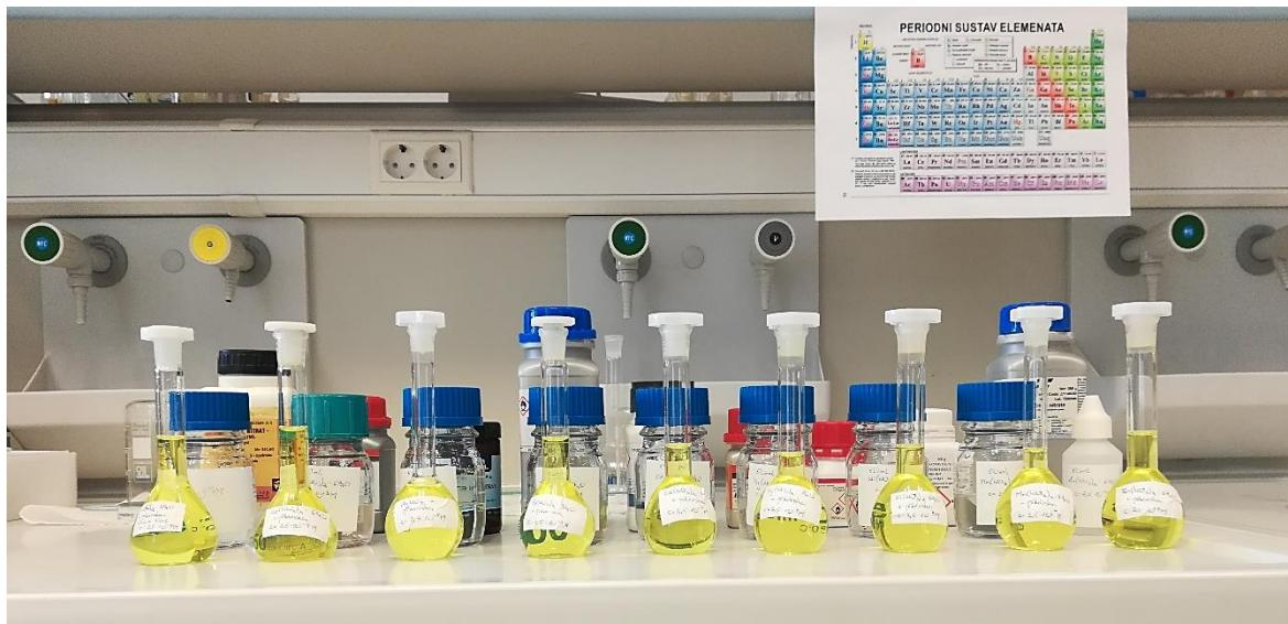
**Slika 17.** Pripremljene otopine metalnih soli koncentracije  $c = 1 \cdot 10^{-4} M$ .
