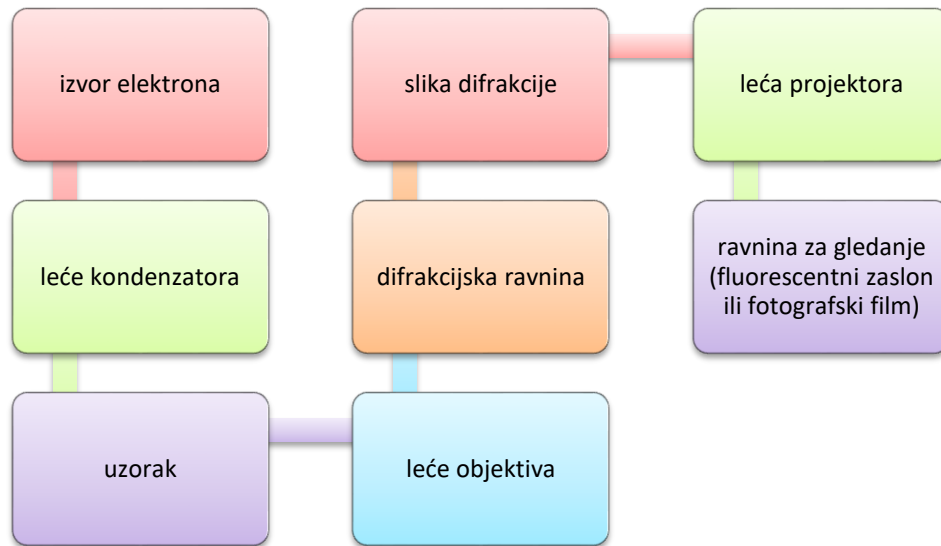
Slika 19. Osnovne komponente transmisijskog elektronskog mikroskopa.
