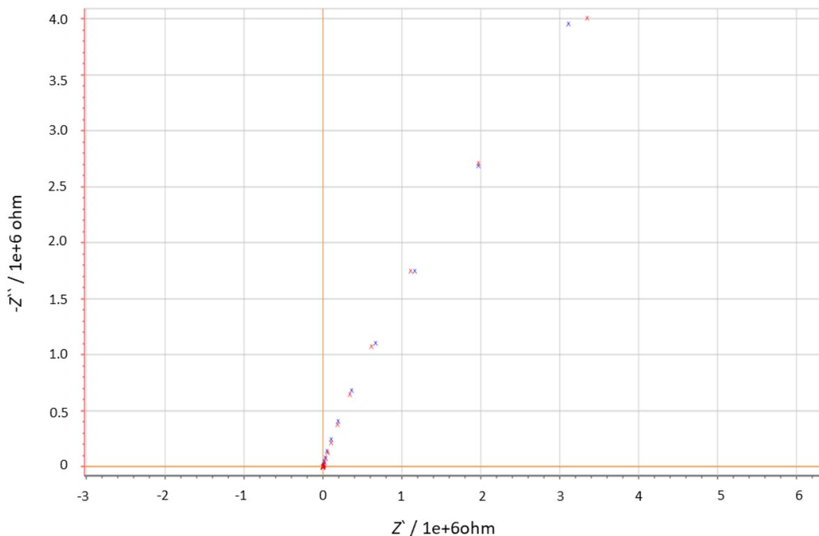
**Slika 24.** Usporedba elektrokemijskih impedancijskih spektara 4E24 tenzidnog senzora (maseni udjel MWCNT 0,04). Eksperimenti su izvedeni pri potencijalu otvorenog kruga ( $E_{oc}$ ) u frekvencijskom području od 100 kHz do 1 MHz s amplitudom pobudnog signala 10 mV. (x) eksperimentalno dobiveni spektar, (x) matematički modelirani spektar.
