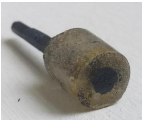
*Slika 12. Prikaz MWCNT tenzidnog senzora.*
