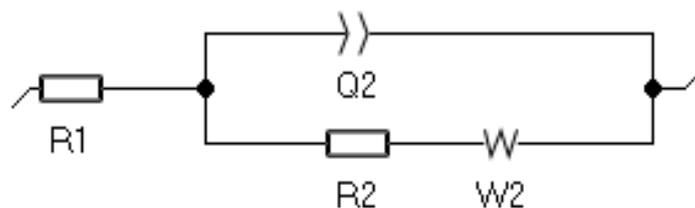
**Slika 23.** Model strujnog kruga za MWCNT tenzidni senzor.  $R_1$ , otpor otopine;  $R_2$  otpor prijenosu naboja;  $Q_2$  kapacitet dvosloja na međupovršini MWCNT/otopina,  $W$  je Warburgov element koji se odnosi na procese difuzije.
