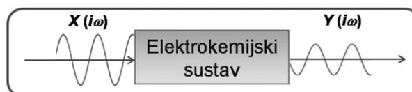
*Slika 5. Shematski prikaz mjerenja impedancije.*
