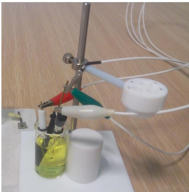
*Slika 14. Troelektrodna elektrokemijska ćelija korištena u ovom radu.*
