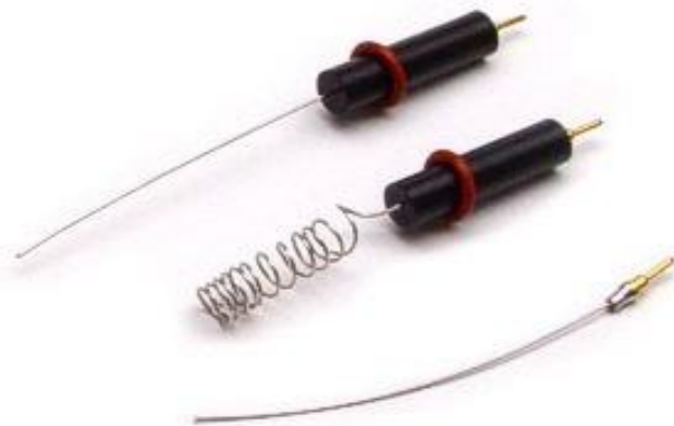
Slika 10. Protuelektroda platinska žica [21].
