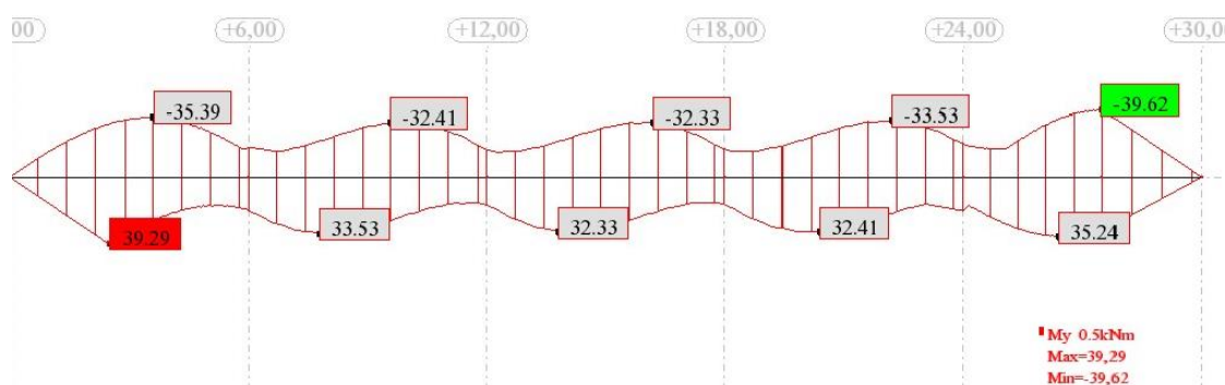
Slika 5 - Anvelopa momenata savijanja oko slabije osi M_{z,Ed} (skupina opterećenja 1, najveći moment oko slabije osi M_{z,Ed} )
