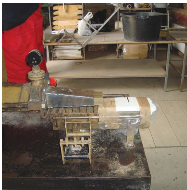
Slika 3. Strojna izrada opeka
