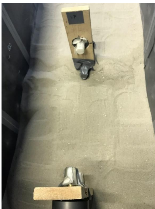
Slika 40. Benderovi elementi postavljeni u spremniku s pijeskom.
