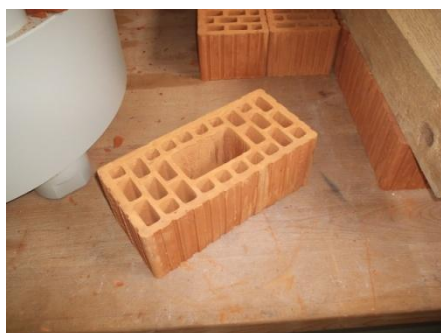
Slika 2.15. Zidni element u izvornom obliku (gore) i prilagođen mjerilu uzorka (dolje) s izmjerama u cm
