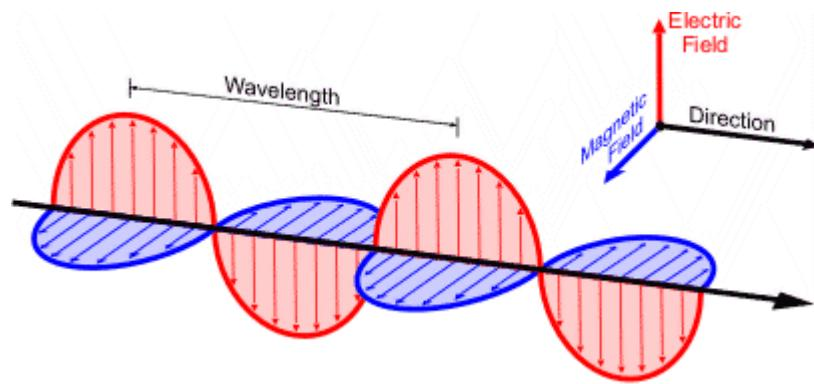
Slika 1. Elektromagnetski val [4]
