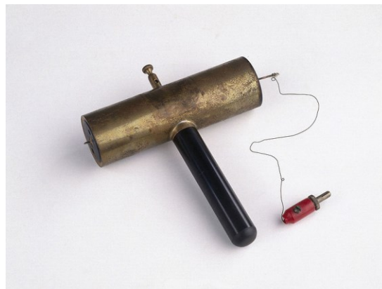
Slika 22. Rana verzija Geiger – Müllerova brojača napravljena 1932. godine za korištenje u laboratoriju [42]
