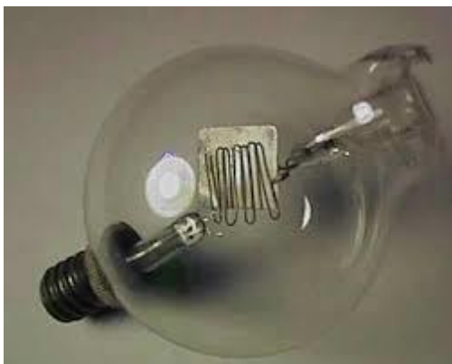
Slika 2.1: Prvi Audion s dvije elektrode [1]
