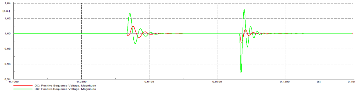
Slika 5.31 Napon na DC sabirnici STATCOM - a
