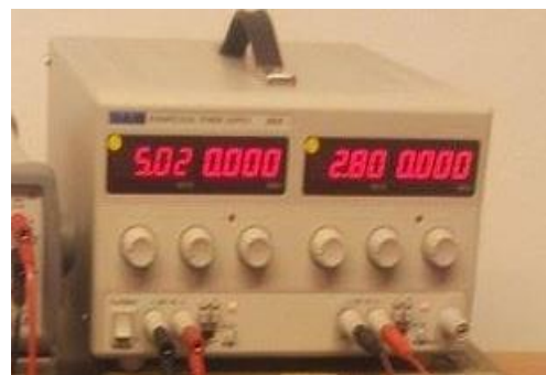
b) Izvor referentnoga napona i mjernoga napona
