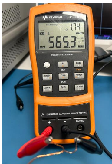
Sl. 5-1 Mjerenje induktiviteta PI zavojnice RLC-metrom
