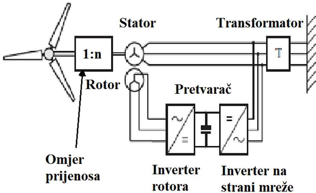
**Slika 3.4.** Dvostruko napajani asinkroni generator u sustavu vjetroturbine [7]
