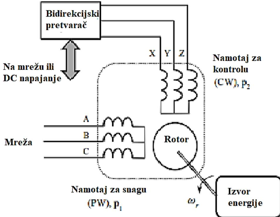
Slika 3.6. Sustav generatora sa dvostrukim statorskim namotajem [13]
