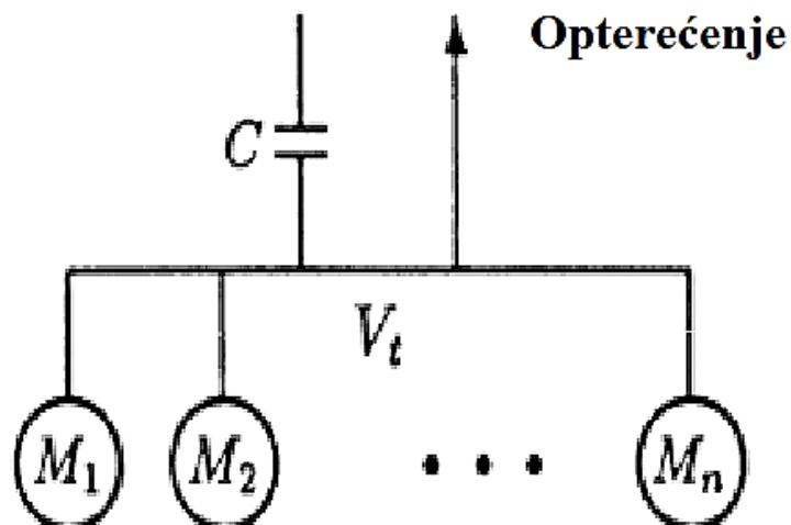
Slika 4.1 Sustav  $n$  asinkronih strojeva spojenih u paralelu [14]
