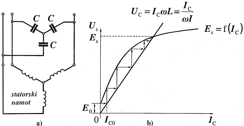
**Slika 2.6.** Samouzbudni asinkroni generator a) priključak kondenzatora na statorski namot, b) princip samouzbude [2]
