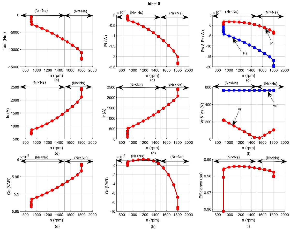
**Slika 3.5.** Karakteristika stacionarnog stanja dvostruko napajanog asinkronog generatora nazine snage 2 megavata i magnetizacije rotora  $idr = 0$  [8]
