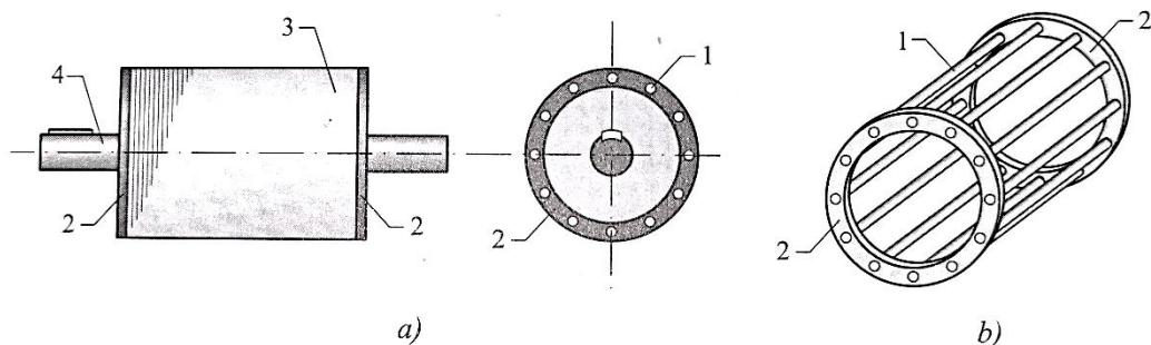
Slika 2.3. a) kavezni rotor b) kavezni namot
