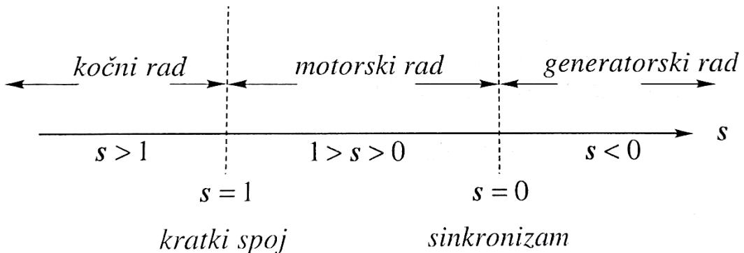
Slika 2.7. Područje rada asinkronog stroja u ovisnosti o klizanju [2]
