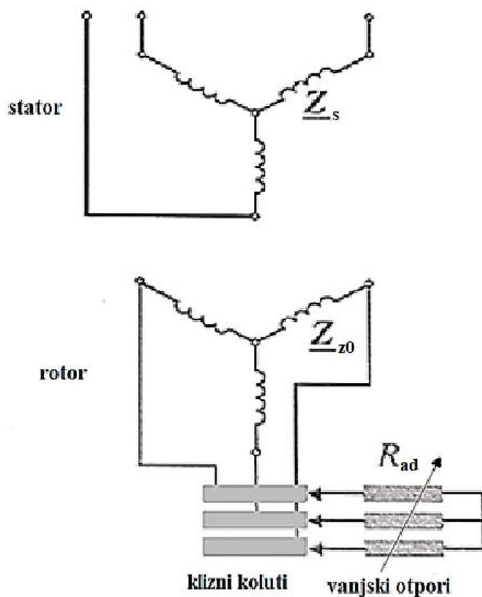
Slika 2.2. Shematski prikaz trofaznog kolutnog asinkronog stroja [2]
