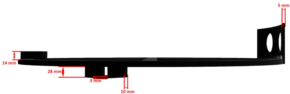
**Slika 3.8.** Tehnički nacrt kostura čistača s bočne strane.
