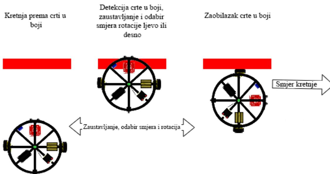
Slika 2.2. Prikaz detekcije crte u boji i reakcija na crtu u boji .
