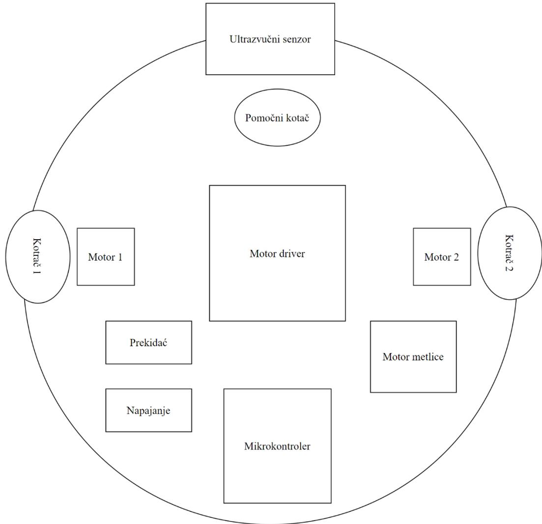
**Slika 2.4.** Prikaz raspodjele komponenata unutar kućišta čistača.
