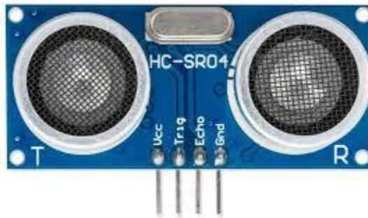
Slika 7.1. Ultrazvučni senzor HC-SR04
