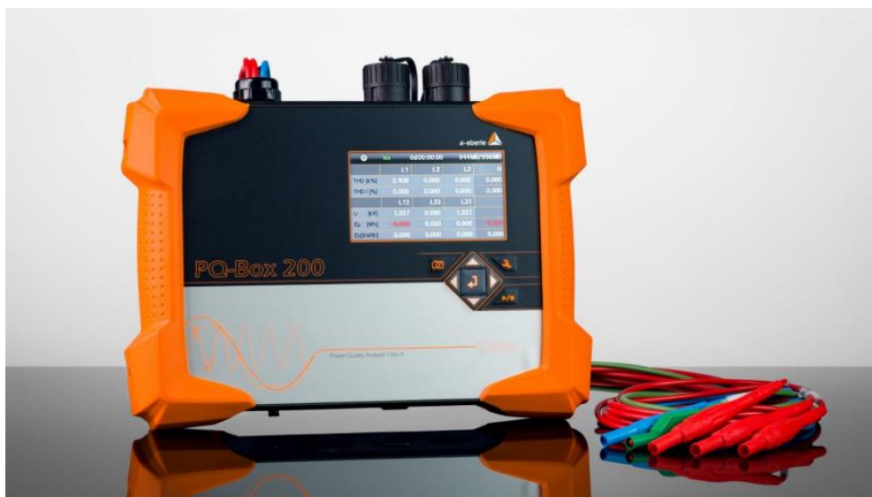
Slika 6.2. Prikaz a-eberle PQ-Box 200 analizatora [20].
