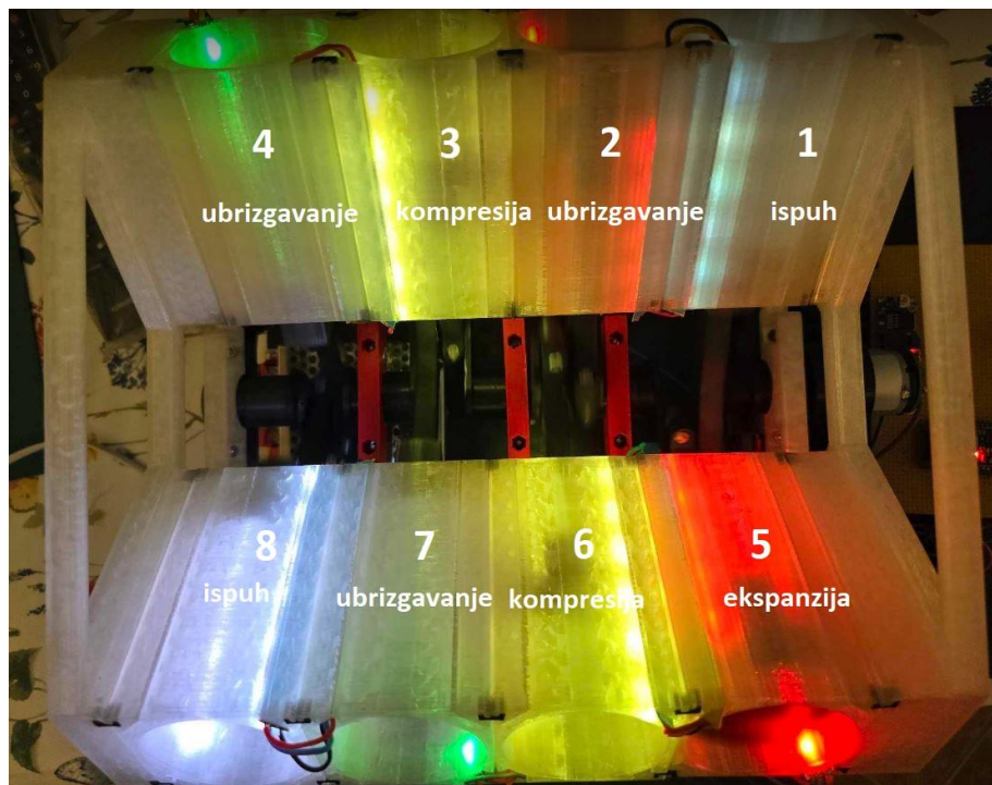
Slika 4.8. Prikaz zajedničkog rada klipova u cilindrima
