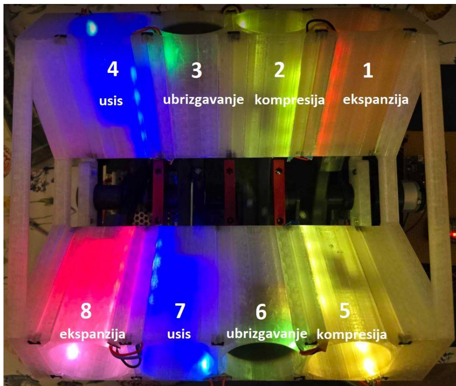
Slika 4.7. Prikaz zajedničkog rada klipova u cilindrima
