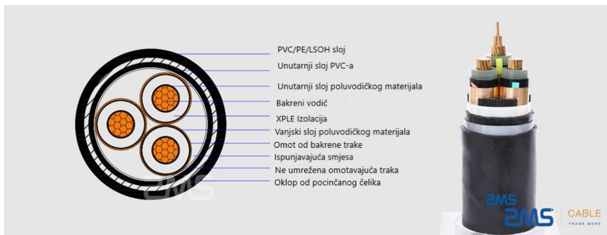
Slika 2.12 Primjer kabla s tri jezgre (1x3) tvrtke "ZMS CABLE" [12]
