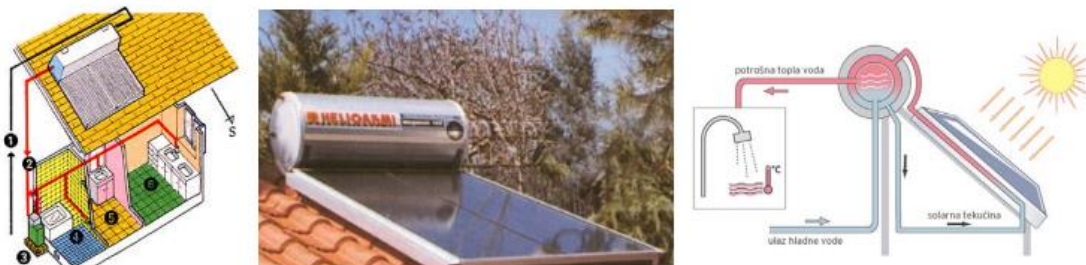
Slika 2.8. Termosifonski sustav s prirodnom cirkulacijom [1]
