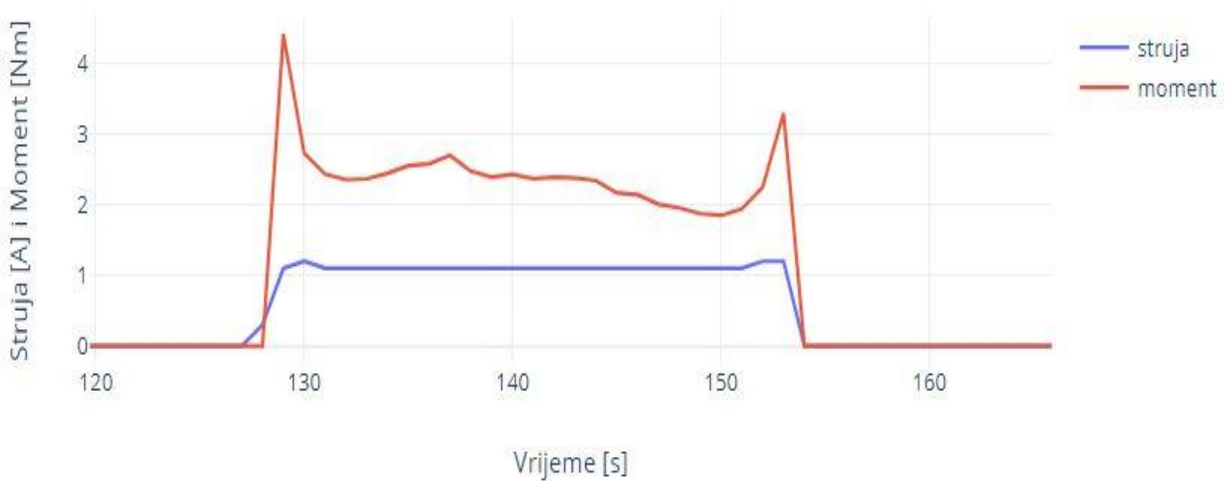
Slika 4.5 – Grafički prikaz struje i momenta sa rampom 10s i teretom.
