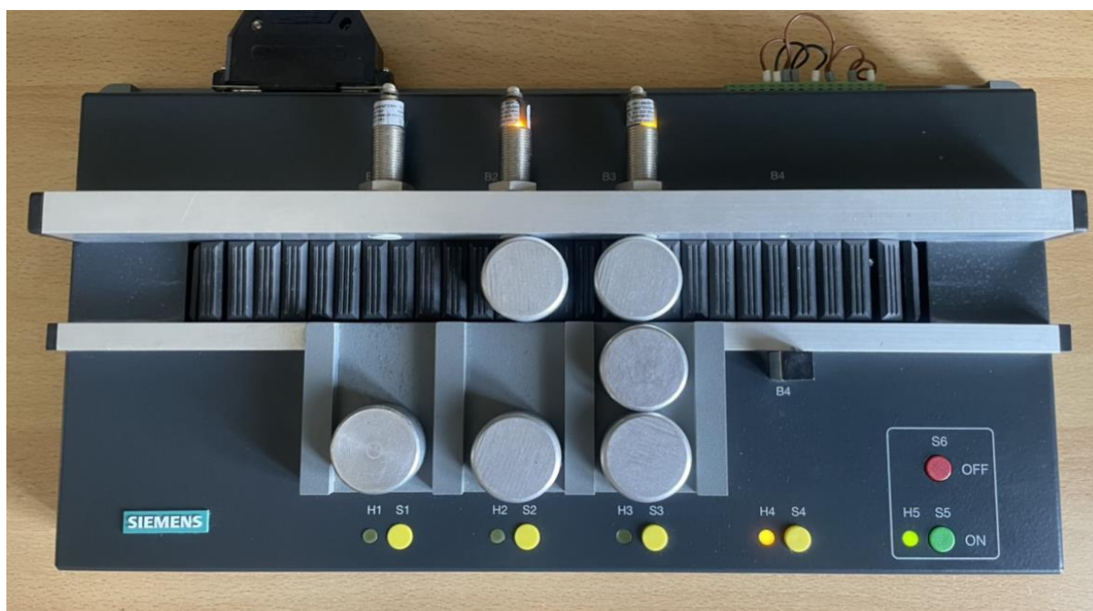
Slika 4.13. Pokretna traka – Status alarm H4
