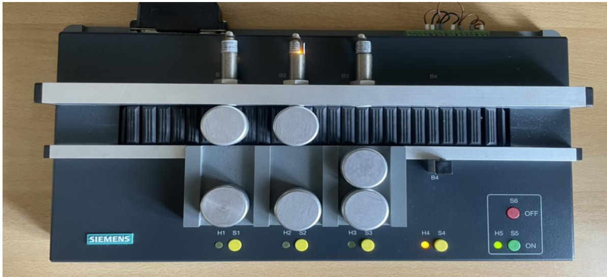
Slika 4.9. Pokretna traka – Status alarm H4
