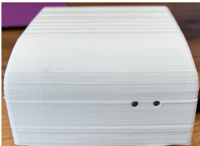
Slika 3.17. Prikaz sonde za detekciju vode koje se nalaze na kućištu uređaja.
