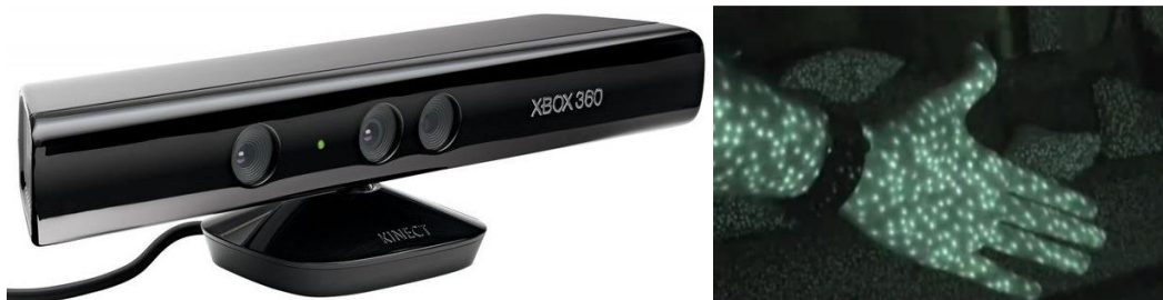
Slika 4.2. Microsoft Kinect v1 kamera (lijevo); Strukturirani infracrveni uzorak svjetlosti (desno)
