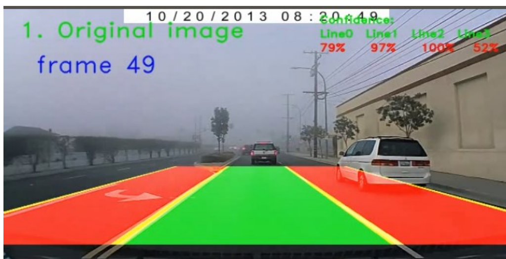
Slika. 4.2. Primjer točne detekcije linija na cesti na 49. okviru iz snimke „Foggy_YW_Straight_NT_1.mp4“
