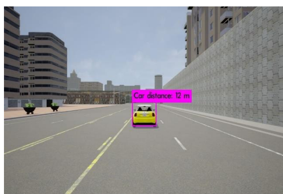
Slika 4.12. Prikaz detekcije i procjene udaljenosti za prednju stranu a), b), e), g), i), k), m) i stražnju stranu b), d), f), h), j), l), n), o) automobila 10 m
