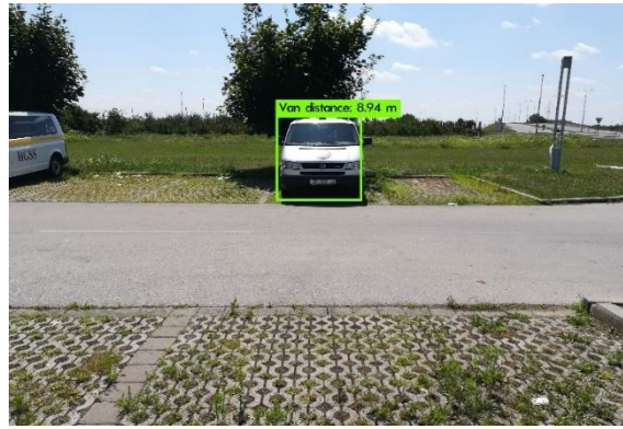
Slika 4.9. Prikaz detekcije i procjene udaljenosti za prednju stranu a), c), e), g), i), k) i stražnju stranu b), d), f), h), j) kombija na 10 m
