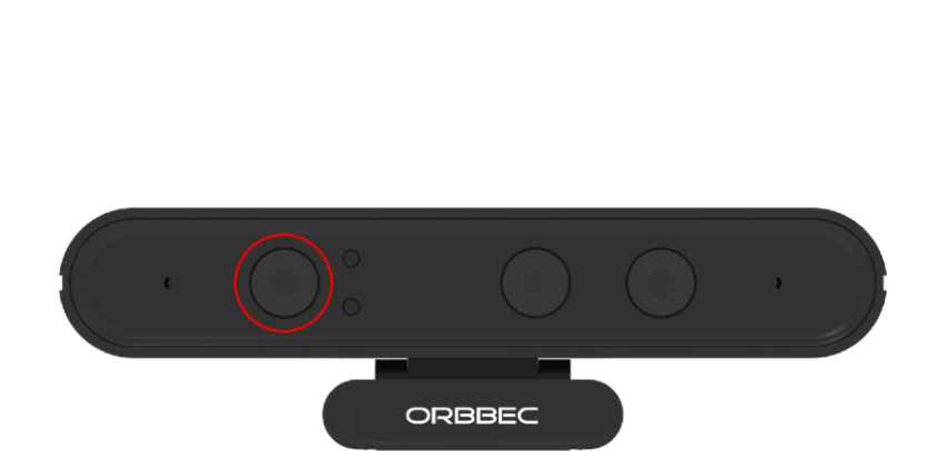
Slika 3.8 Orbbec Astra kamera s označenim projektorom
