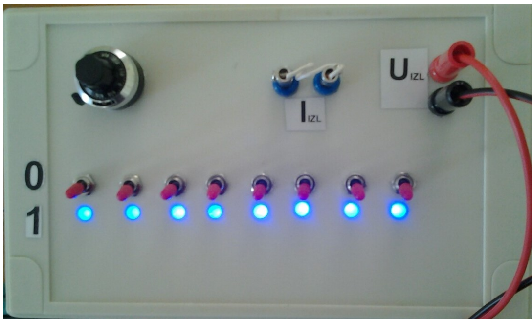
Slika 4.14 Pogled odozgo na praktični izveden R2R D/A pretvarač
