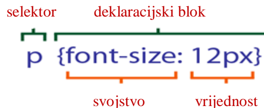
Sl. 2.2. Primjer CSS sintakse [2]
