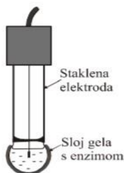
Ilustracija 4.2. Enzimska indikatorska elektroda [13]
