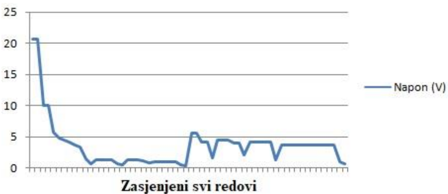
Slika 4.25. Napon pri kompletno zasjenjenom modulu odnosno svih 10 redova.
