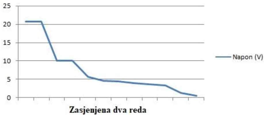
Slika 4.23. Promjena napona pri zasjeni dva reda fotonaponskog modula.
