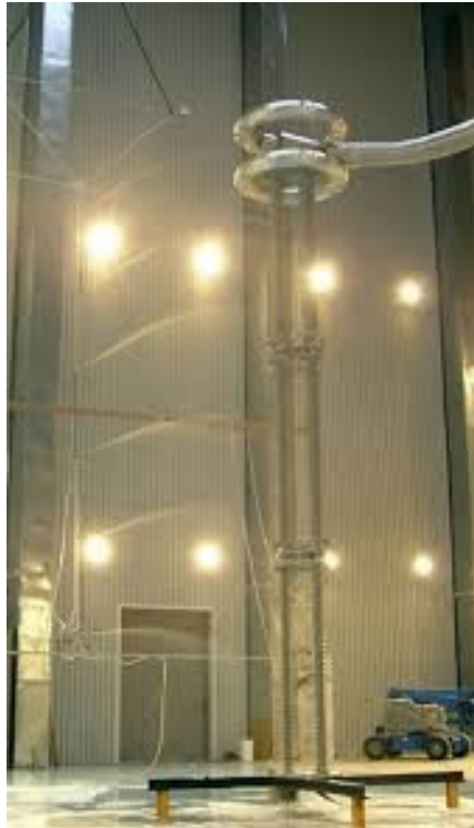
Sl.3.1.1. Prikaz ispitivanja umjetnom kišom
