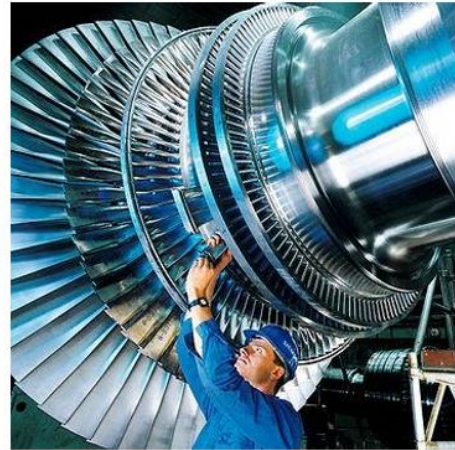
Rotor reakcijske parne turbine
