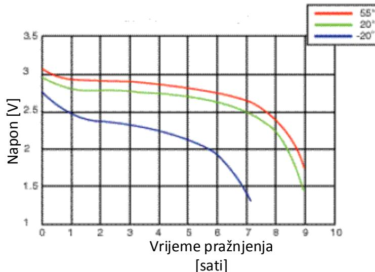
Slika 4.2. Ovisnost performanse litij-ionske baterije o temperaturi [7]
