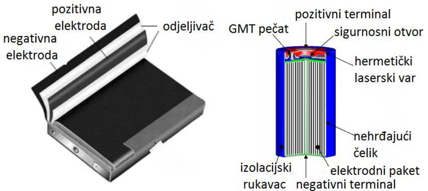
*Slika 3.8. Prizmatska (lijevo) i cilindrična (desno) konstrukcija Li-ionskih čelija [3]*
