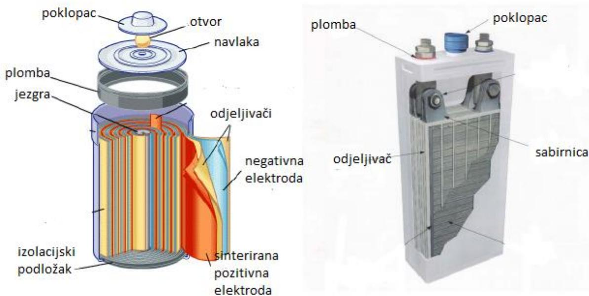
Slika 3.5. Shema spiralnih (lijevo) i prizmatskih (desno) konstrukcija Ni-Cd baterija [3]
