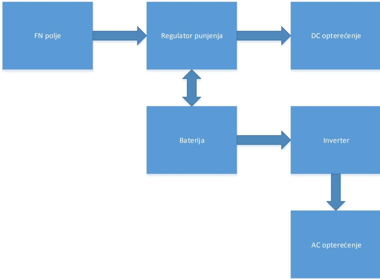
*Slika 2.2. Blok dijagram FN sustava s baterijom*
