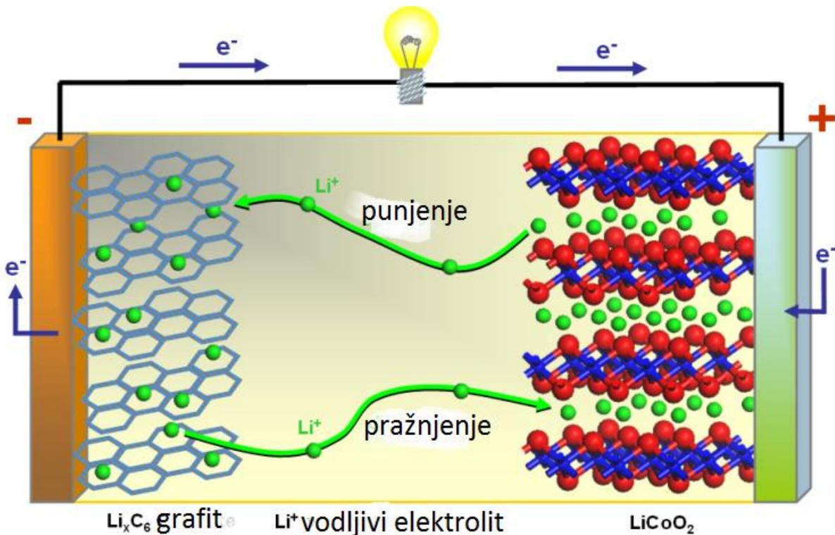
Slika 3.7. Princip rada litij-ionske ćelije [3]
