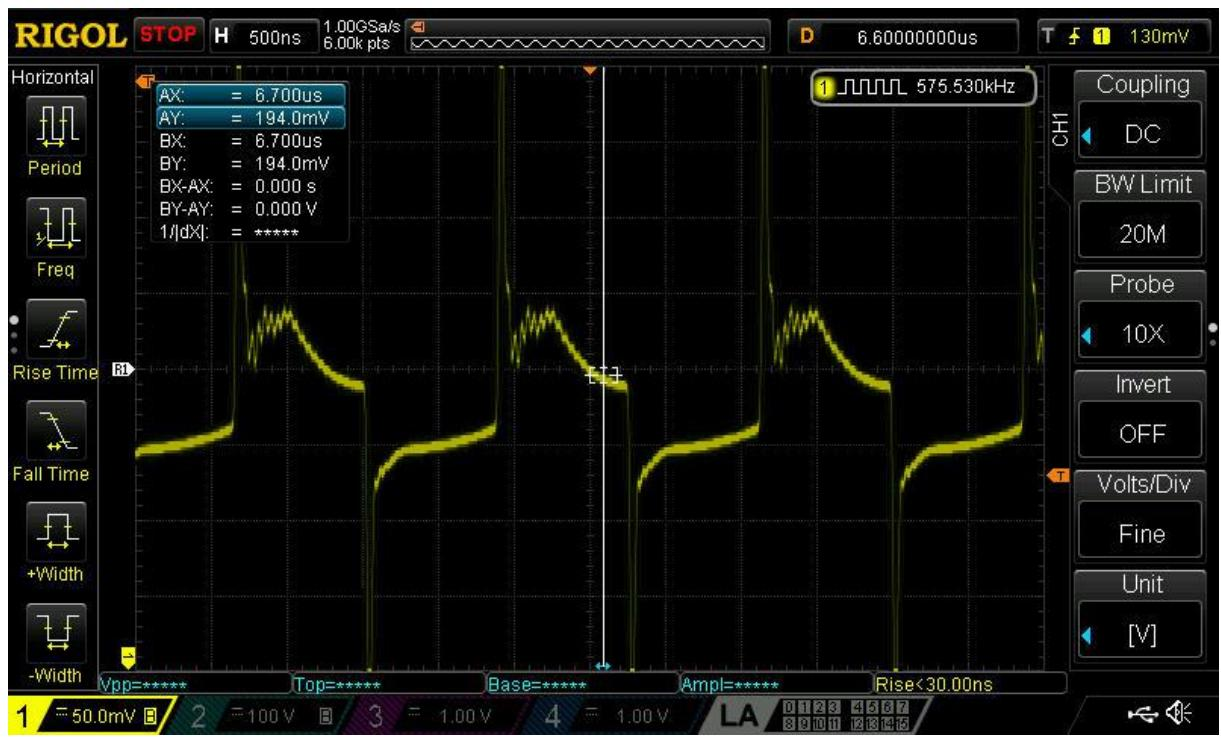
3.1.13 Izgled signala (pravokutnog) na izlazu iz derivatora mjernog kapaciteta  $220\text{pF}$  ( $f=575,5\text{kHz}$ )
