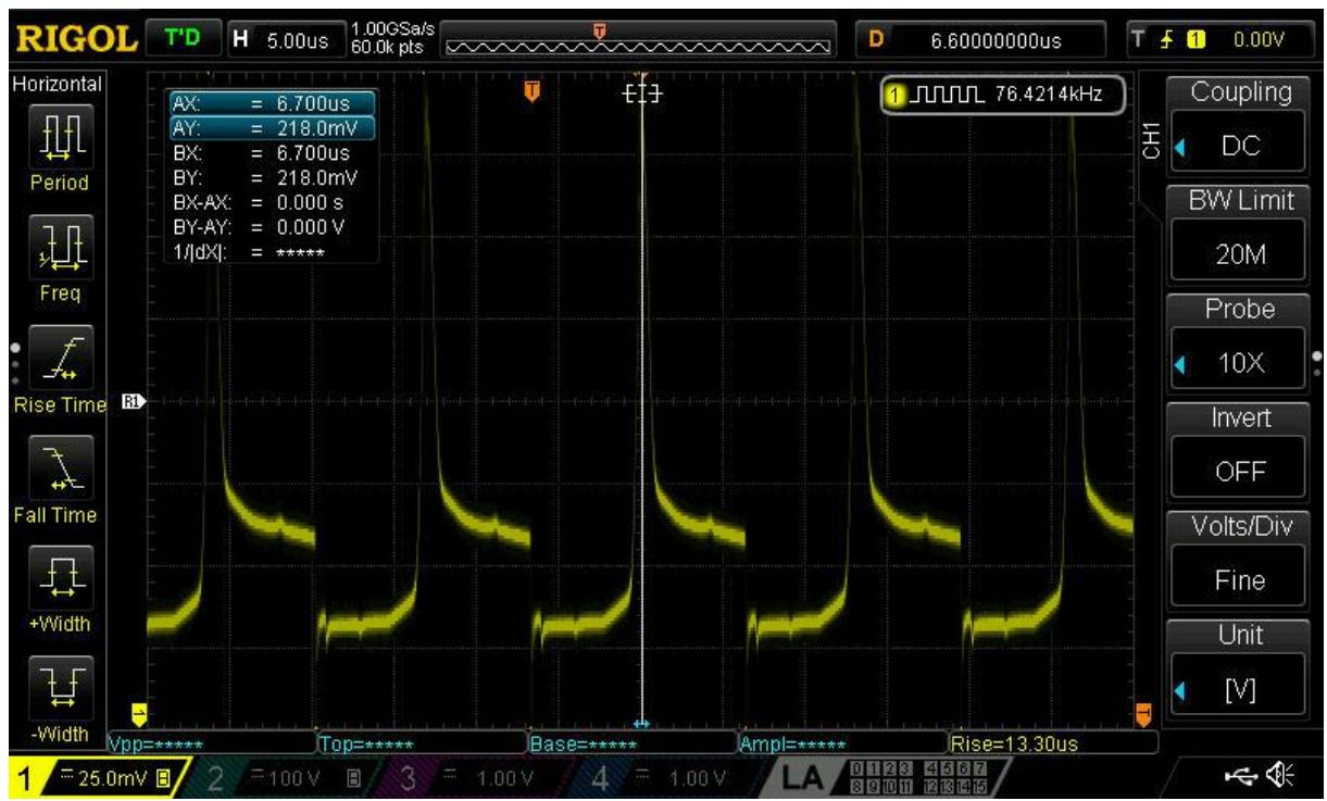
3.1.9 Izgled signala (pravokutnog) na izlazu iz derivatora mjernog kapaciteta  $150\text{pF}$  ( $f=76,42\text{ kHz}$ )
