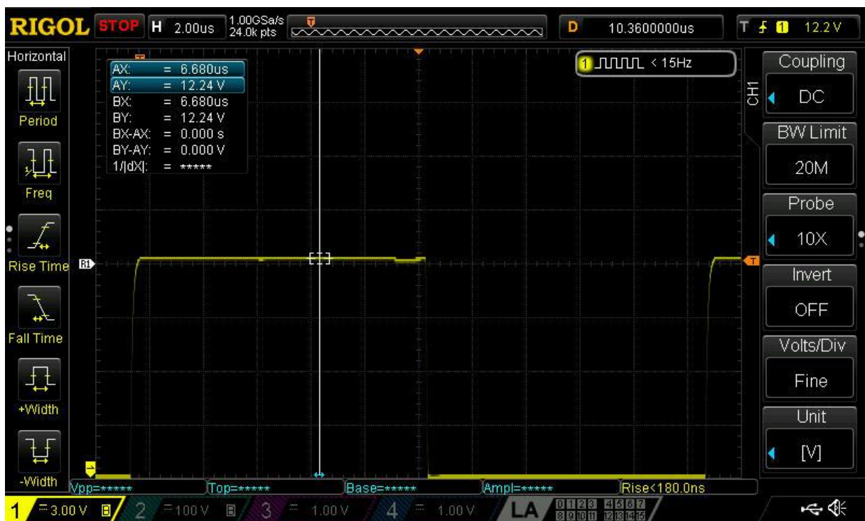
Slika 3.2.7-Signal poslije komparatora za 470pF
