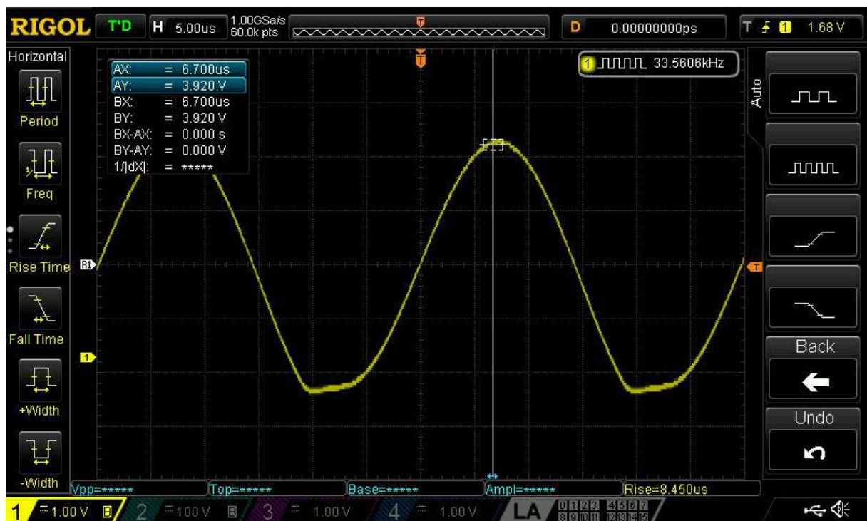
3.1.14 Izgled signala (sinusnog) na ulazu u derivator mjernog kapaciteta 68pF ( f=33,56\text{kHz} )
