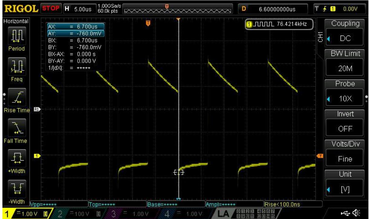
3.1.3 Izgled signala(pravokutnog) pri ulazu u derivator mjernog kapaciteta  $150\text{ pF}$  ( $f=76,42\text{ kHz}$ )
