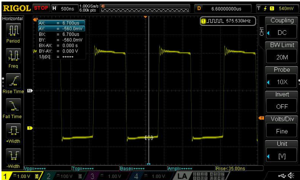
3.1.7 Izgled signala(pravokutnog) pri ulazu u derivator mjernog kapaciteta 220 pF( f=575,5\text{kHz} )
