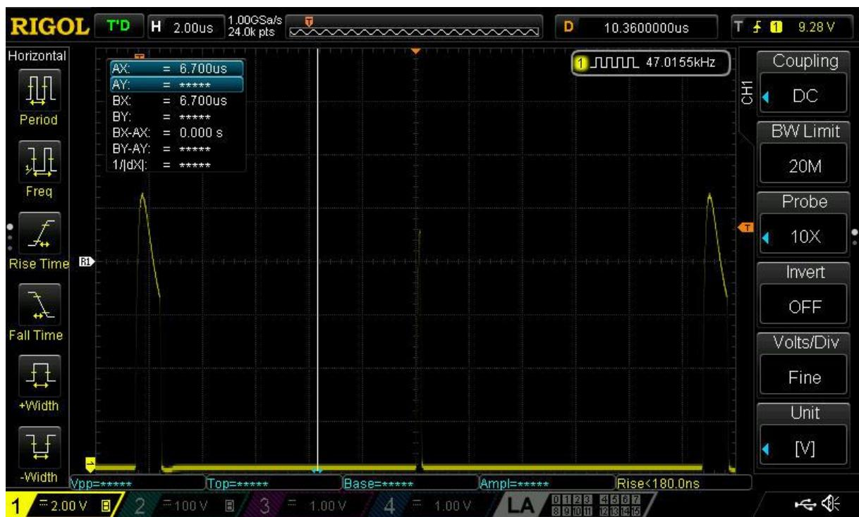
Slika 3.2.8-Signal poslje komparatora uslijed djelovanja induktiviteta za kondenzator kapaciteta  $56\text{pF}$
