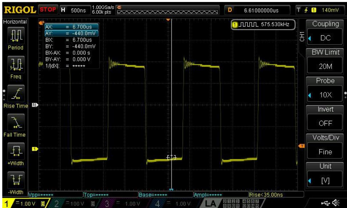
3.1.6 Izgled signala (pravokutnog) pri ulazu u derivator mjernog kapaciteta  $150 \text{ pF}$  ( $f=575,5 \text{ kHz}$ )
