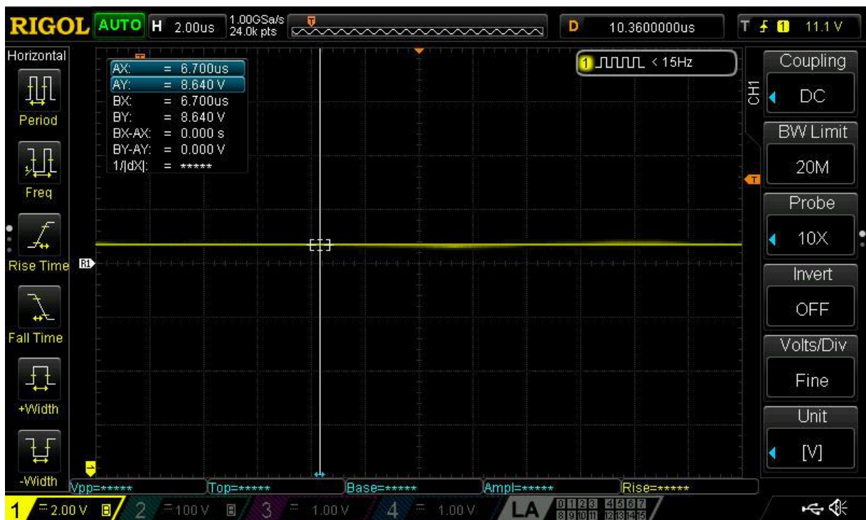
Slika 3.2.13-Konstantni napon nakon induktivneta za 470pF
