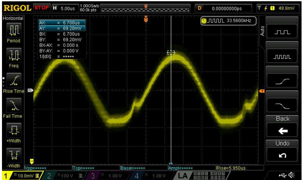
3.1.16 Izgled signala (sinusnog) na izlazu iz derivatora mjernog kapaciteta  $68\text{pF}$  ( $f=33,56\text{kHz}$ )
