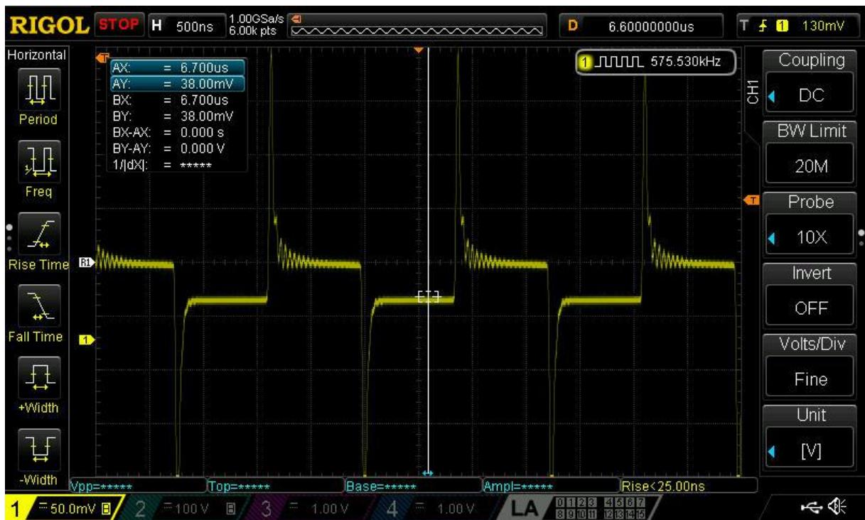
3.1.12 Izgled signala (pravokutnog) na izlazu iz derivatora mjernog kapaciteta  $150\text{pF}$  ( $f=575,5\text{kHz}$ )
