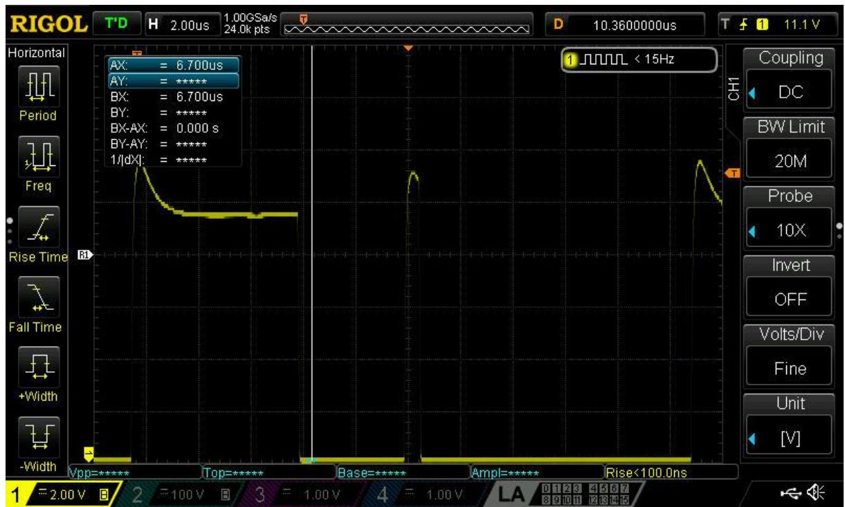
Slika 3.2.10-Signal poslje komparatora uslijed djelovanja induktiviteta za kondenzator kapaciteta  $470\text{pF}$
