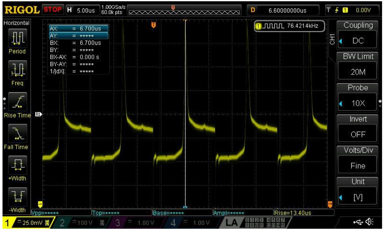
3.1.10 Izgled signala (pravokutnog) na izlazu iz derivatora mjernog kapaciteta  $68\text{pF}$  ( $f=76,42\text{ kHz}$ )
