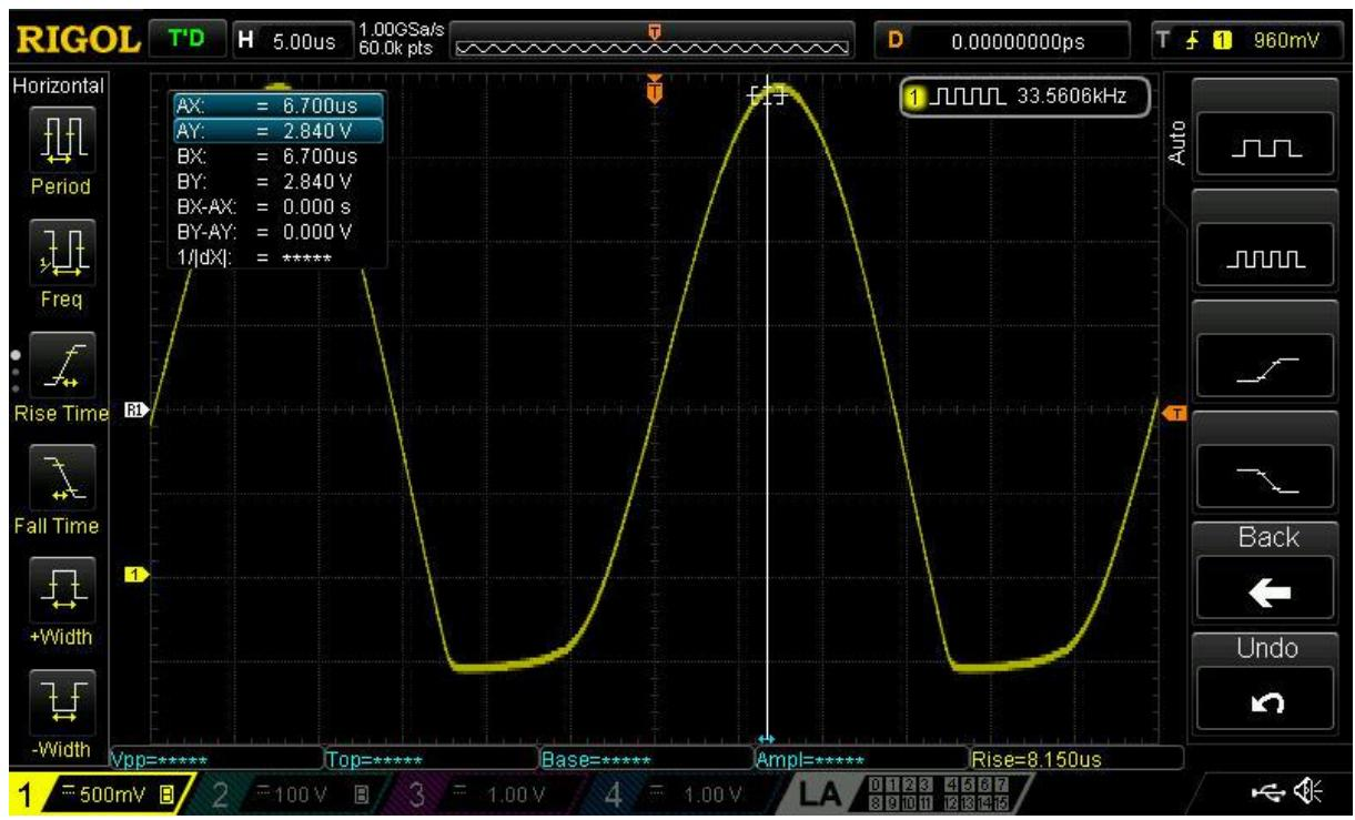
3.1.15 Izgled signala (sinusnog) na ulazu u derivator mjernog kapaciteta  $220\text{pF}$  ( $f=33,56\text{kHz}$ )
