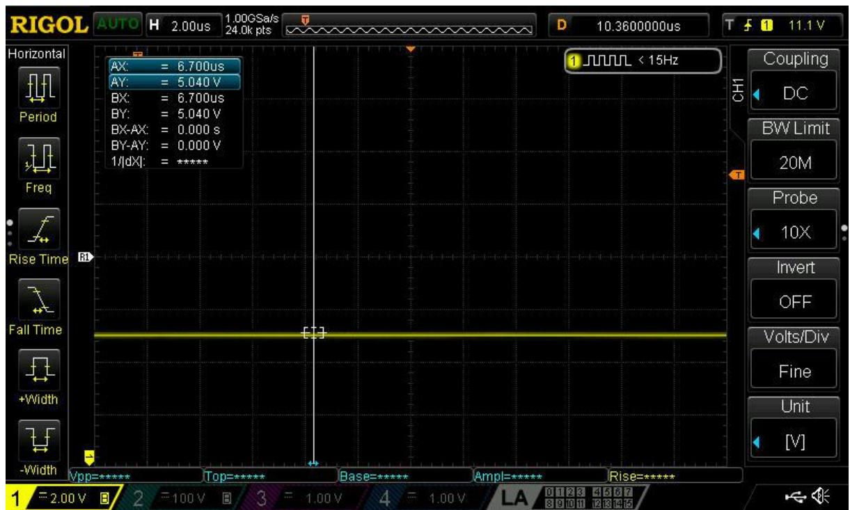
Slika 3.2.12-Konstantni napon nakon induktiviteta za 220pF
