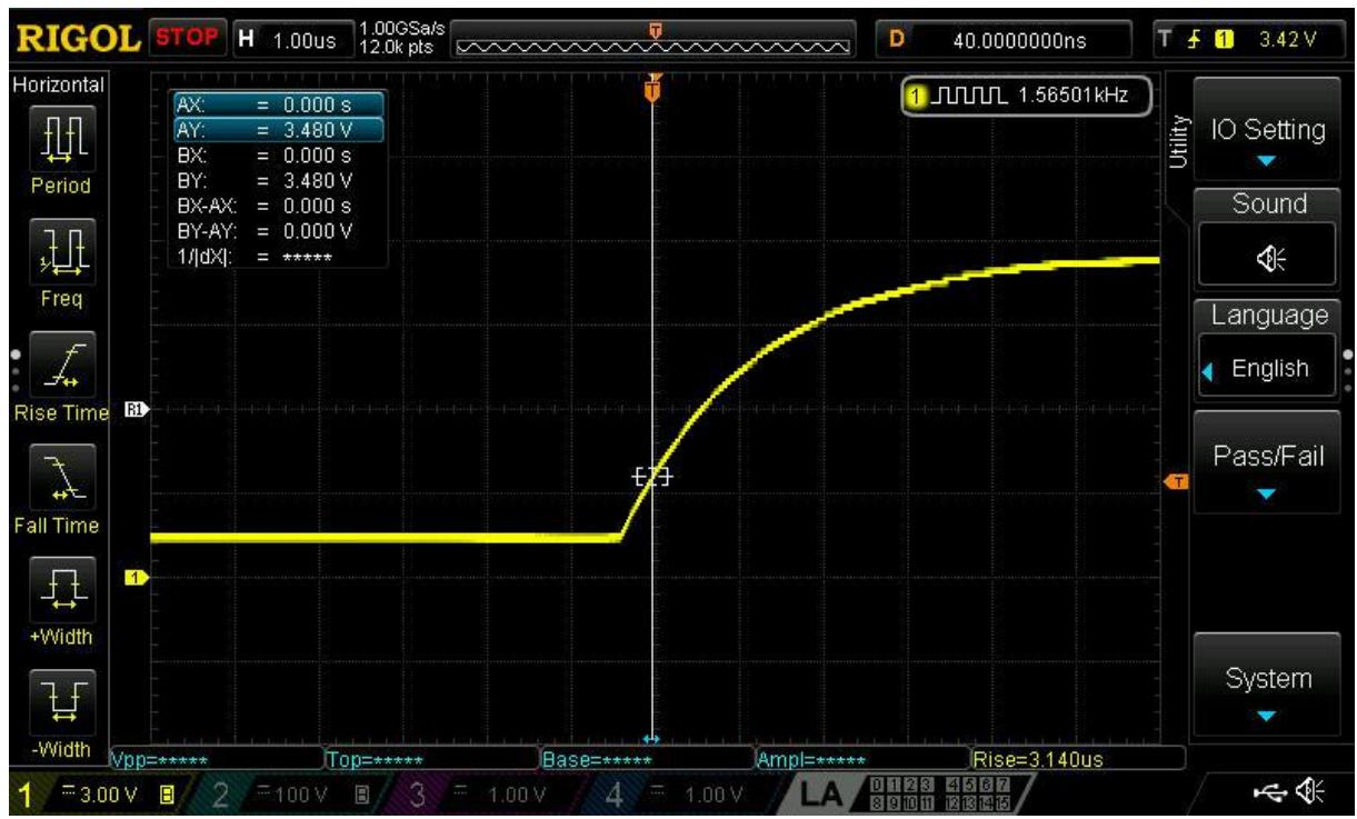
Slika 3.2.3-Punjjenje kondenzatora kapaciteta 220pF( X os- 1.00 $\mu$ s/div, Y os- 3V/div)
