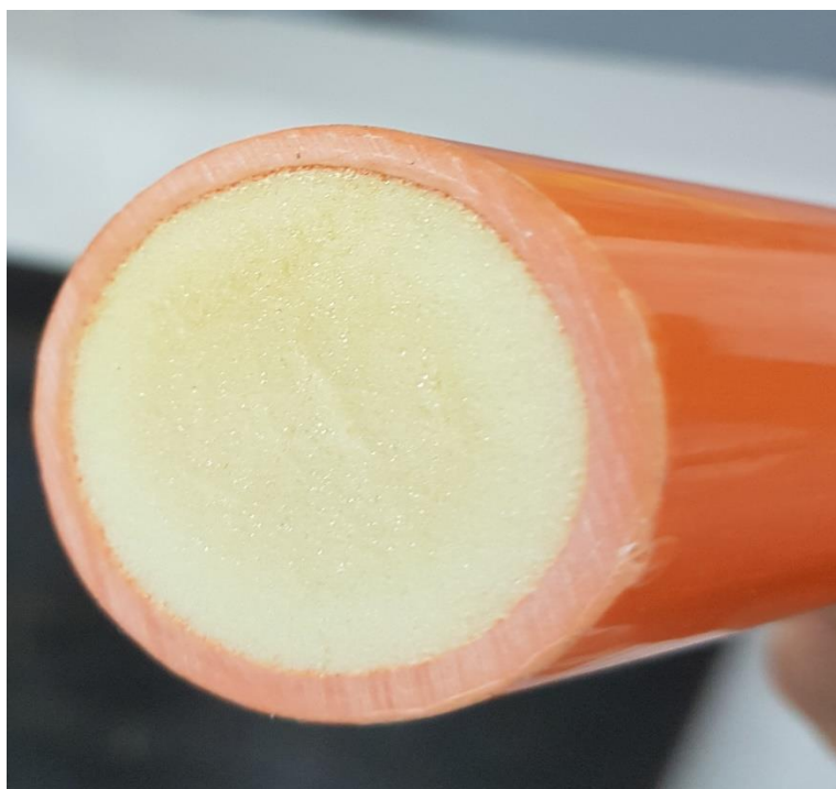
Slika 4.4. Presjek izolacije uzemljivačke motke
