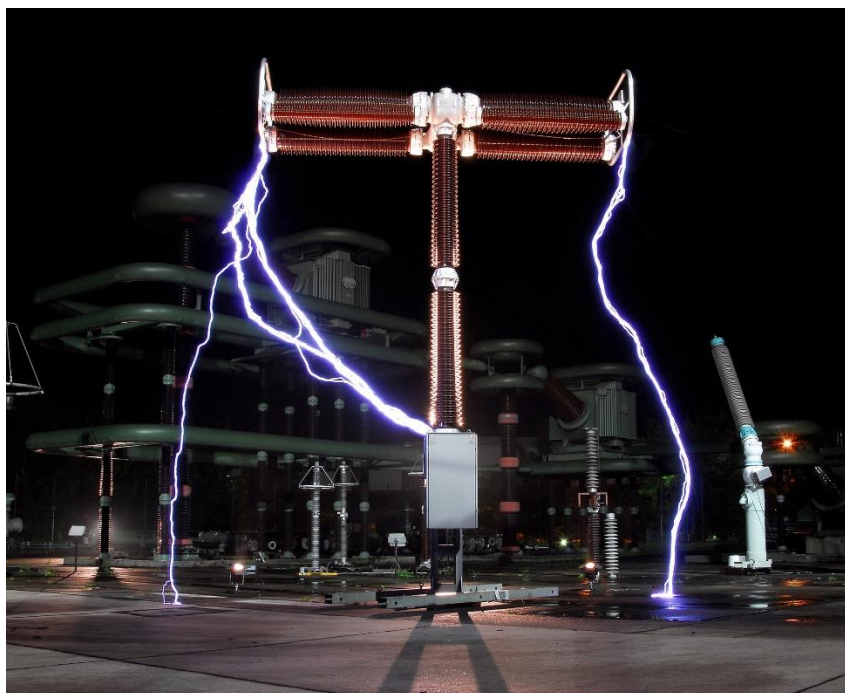
Slika 3.1. Prenaponsko ispitivanje 550 kV-nog VN prekidača
