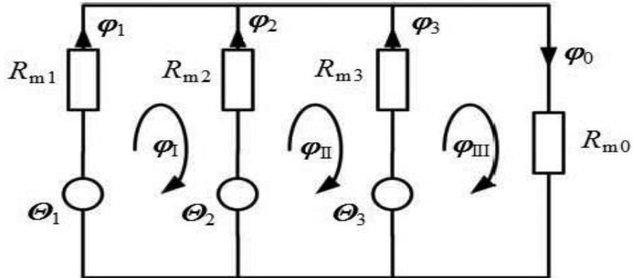
**Slika 3.2.** Nadomjesna shema magnetskog kruga trofaznog transformatora [5].
