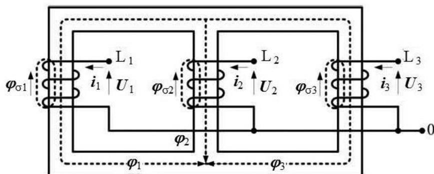
Slika 3.1. Pojednostavljena shema trofaznog transformatora u praznom hodu [5].
