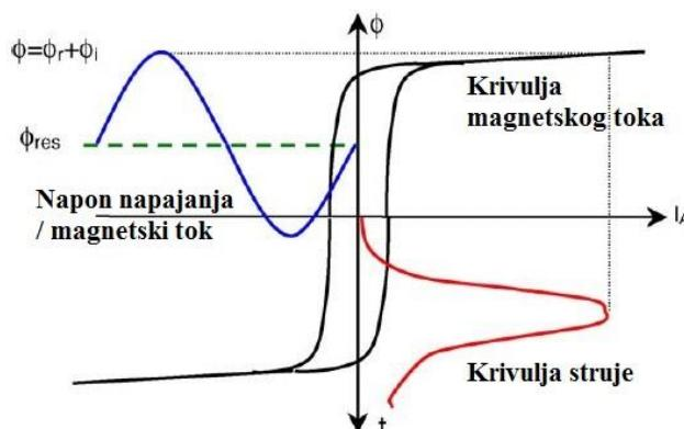
Slika 2.1. Povezanost magnetskog toka i iznosa struje uklapanja
