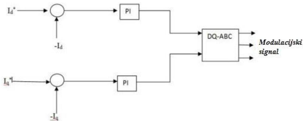
**Slika 4.3.** Blok shema upravljanja sa pulsno širinskom modulacijom [9].
