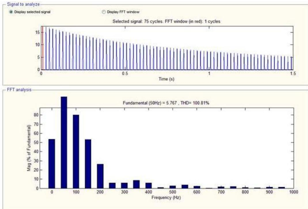
**Slika 2.4.** Primjer harmonika uklopne struje trofaznog transformatora [6]
