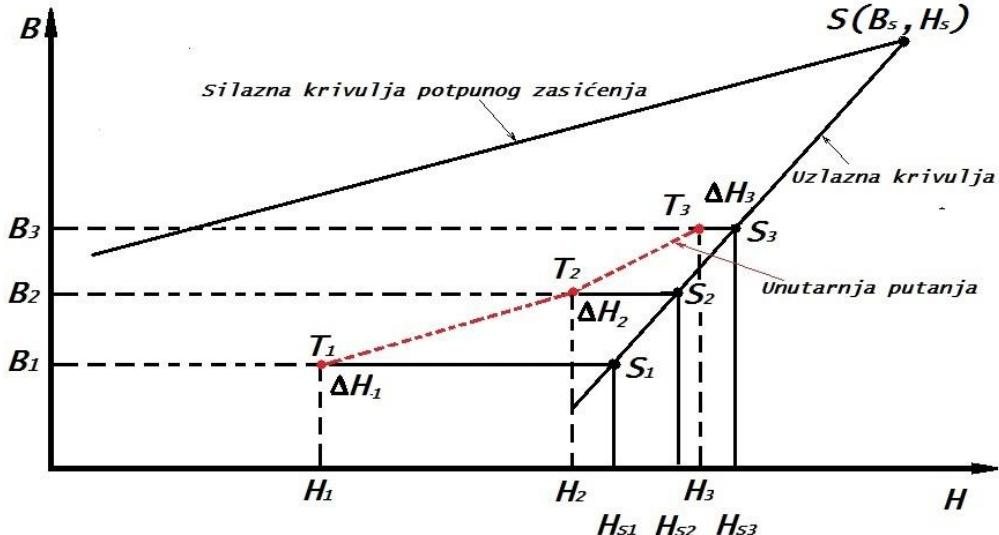
Slika 3.3. Dijagramska prikaz algoritma za određivanje unutarnjih putanja [5]
