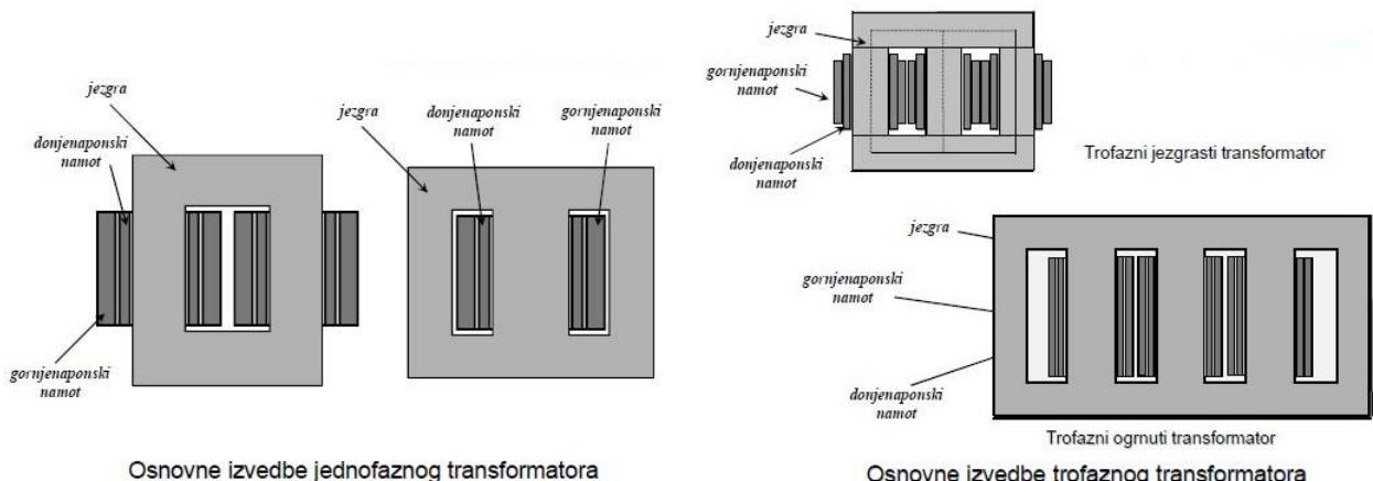
**Slika 2.1.** Osnovne izvedbe jednofaznog i trofaznog transformatora [1].
