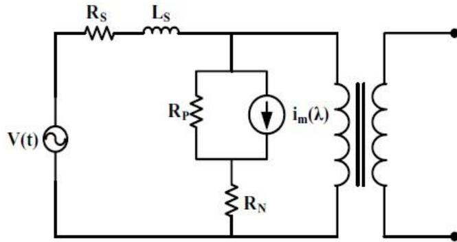
**Slika 4.6.** Ekvivalentna shema transformatora sa neutralnim otpornikom [14]
