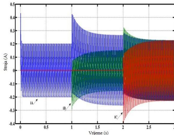
**Slika 4.9.** Smanjenje struje uklopa korištenjem metode sekvencijalnog uklopa [14].
