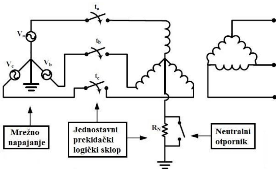
**Slika 4.4.** shema sekvenčnog uklopa faza transformatora sa neutralnim otpornikom[14].
