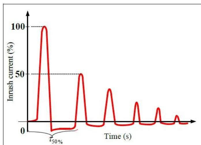
Slika 2.5. Klasičan primjer valnog oblika struje uklopa [6]
