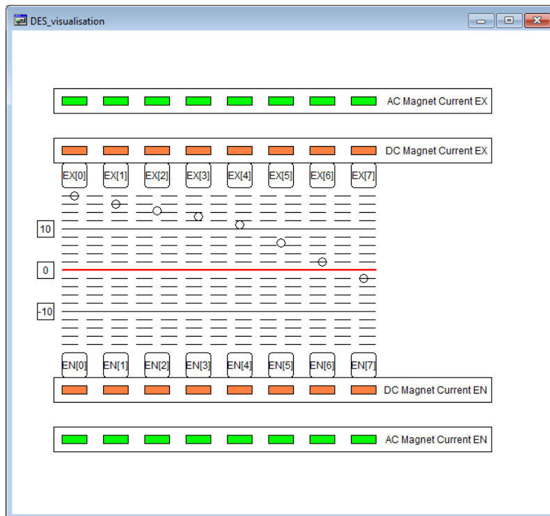
Slika 4.7. Prikaz trake i struja elektromagneta.
