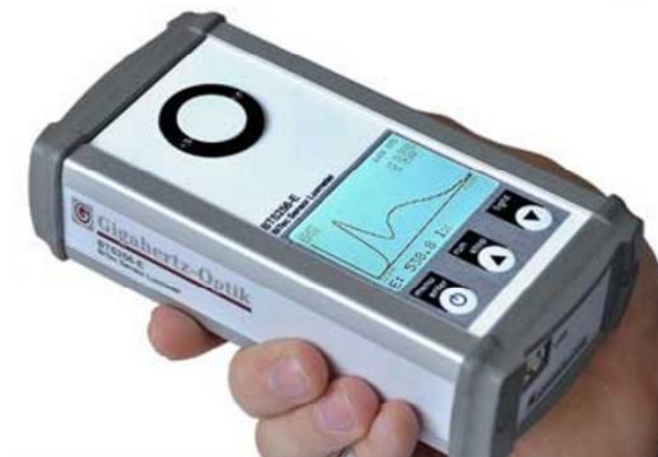
Slika 3.2.2. Primjer uređaja za mjerenje svjetlosti BTS256-E tvrtke Gigahertz - Optik [16]
