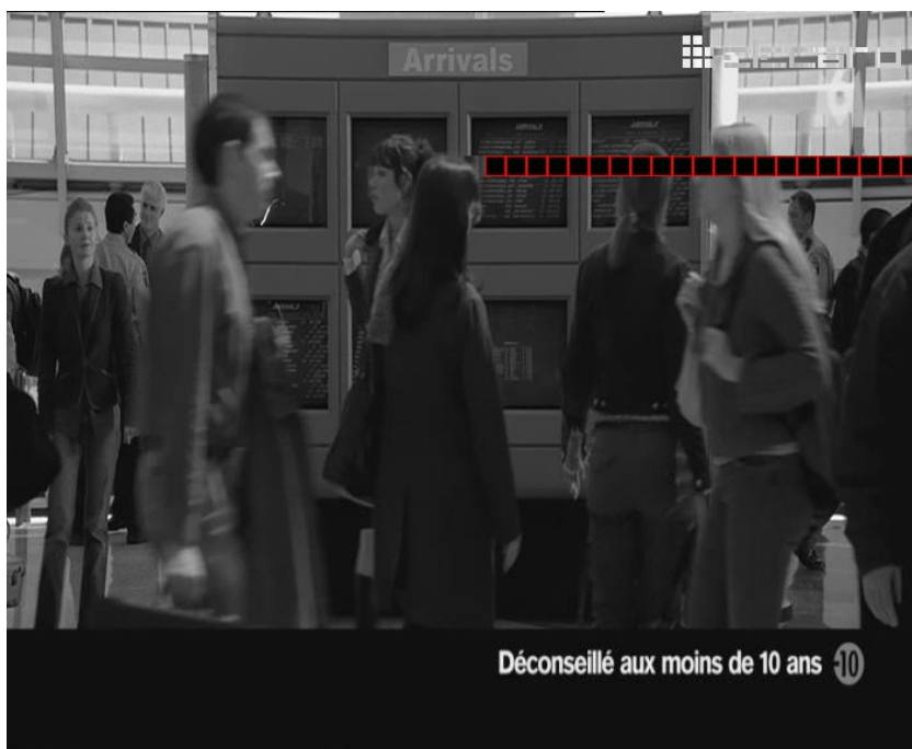
Sl. 4.8. Detektirani pravilni, pravokutni artefakti gubitka paketa
