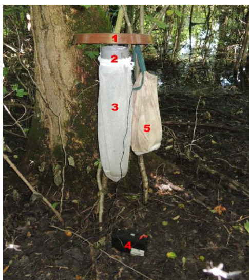
Slika 9. CDC klopka: Poklopac (1), cilindar s ventilatorom (2), mrežica (3), platnena vreća sa suhim ledom (5), baterija (4) (Foto Ivan Kurtek)
