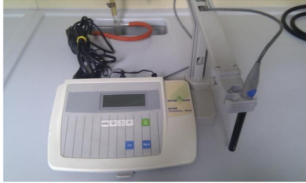
Slika 17. METTLER TOLEDO MC 226 s staklenom kombiniranom elektrodom
